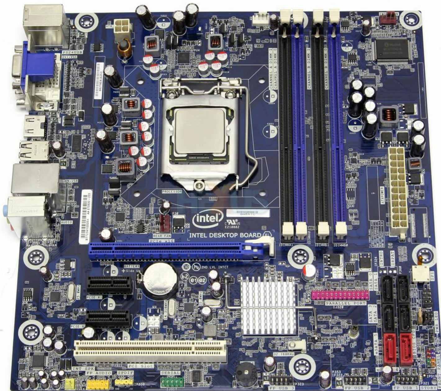
Płyta DH55TC z chipsetem Intel H55 express
