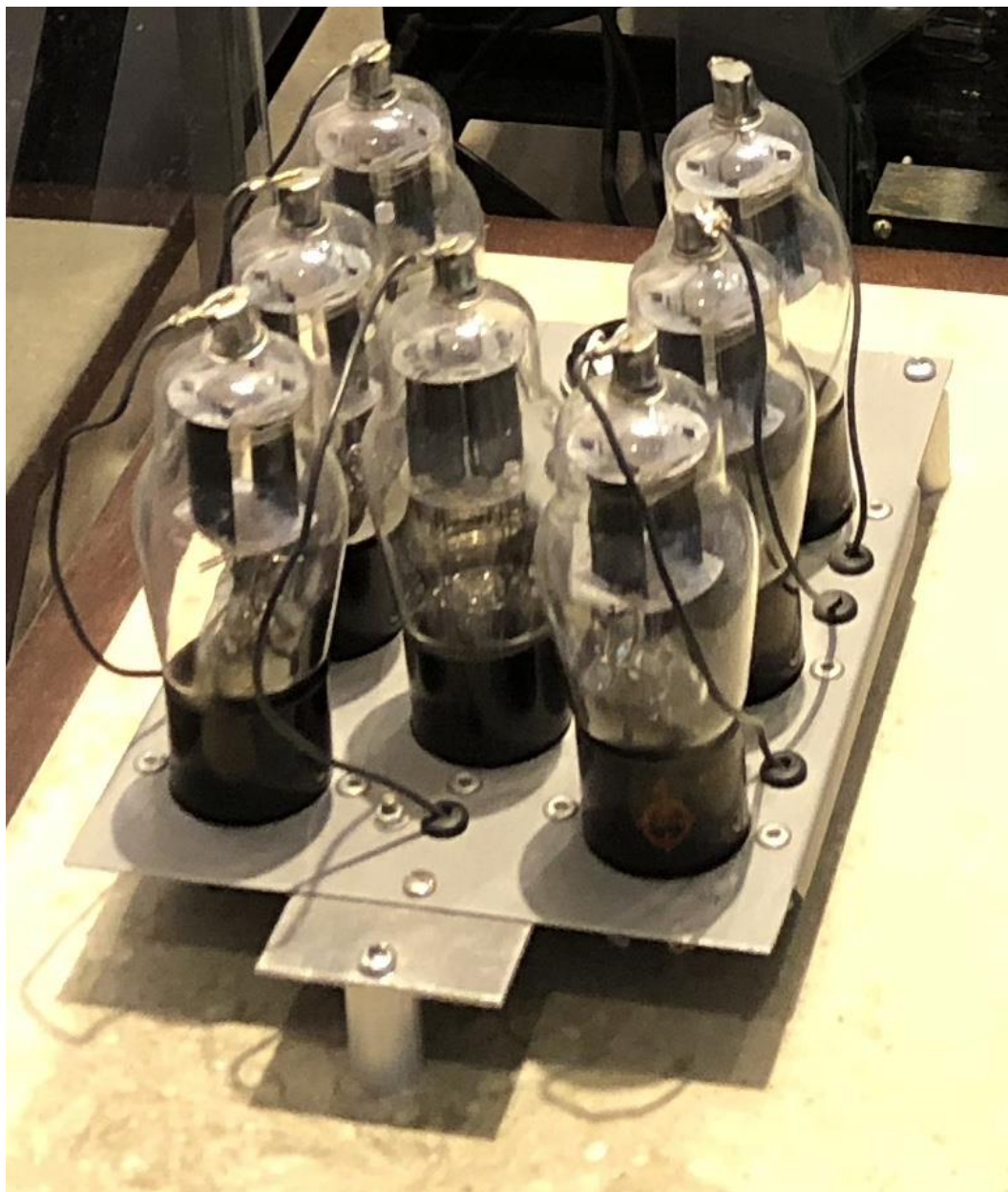
Moduł dodawania-odejmowania z komputera Atanasoff-Berry'ego
