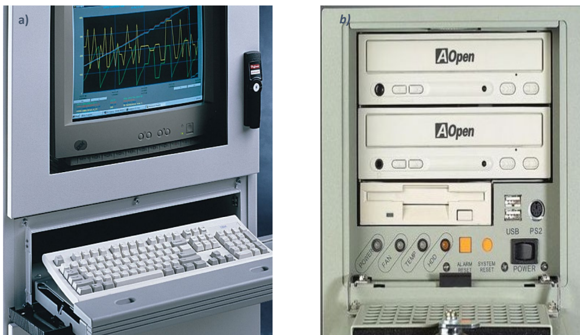
Rysunek 5: Dwa typy sterowników cyfrowych opracowane na bazie architektury komputera typu PC: a) komputer typu PC w szafie sterowniczej firmy Schroff; b) komputer typu PC firmy Advantech
