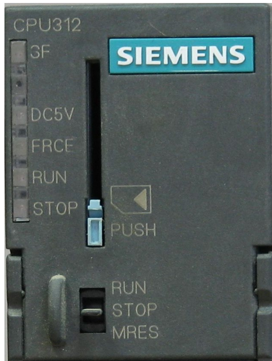
Rysunek 21: Górna część panelu frontowego modułu CPU 312 sterownika PLC rodziny SIMATIC S7 - 300 firmy Siemens
