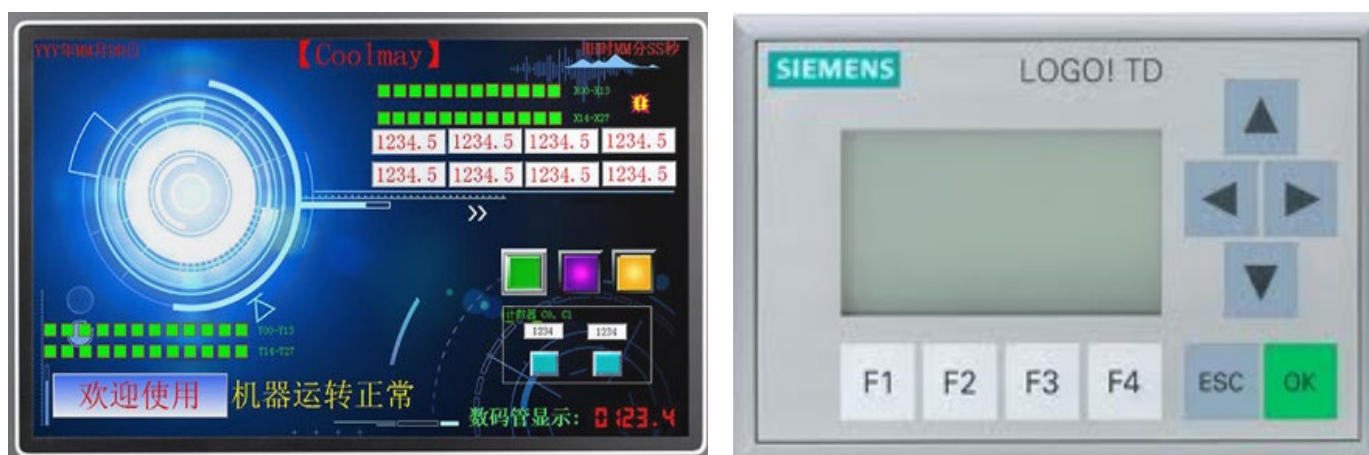
Rysunek 45: Przykłady rozwiązań nowoczesnych „pulpitów” sterujących dla systemów mechatronicznych
