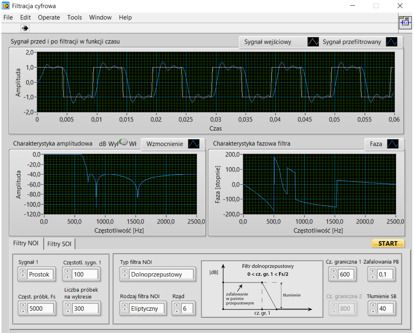
Rys.6.5 Panel czołowy przyrządu wirtualnego – filtr NOI
