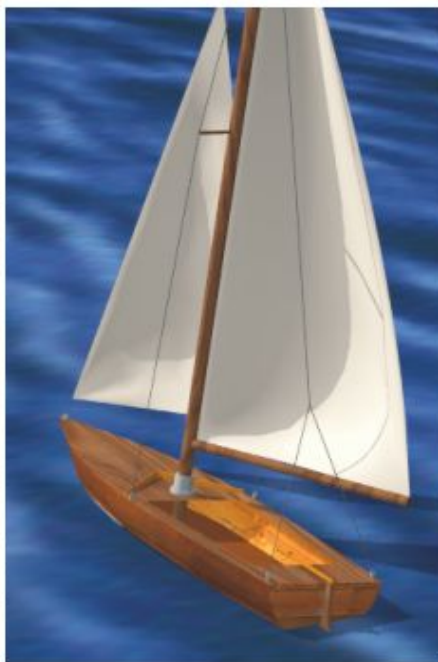
Rysunek 83. Powierzchnia kadłuba rozpięta na wręgach - czyli interpolująca zadane krzywe.
