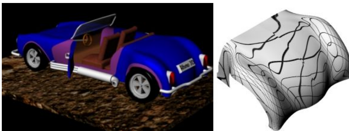
Rysunek 62. Linie refleksów na powierzchni karoserii o nieciągłej krzywiznie mają załamania, choć pocieniowana powierzchnia wygląda na gładką.
