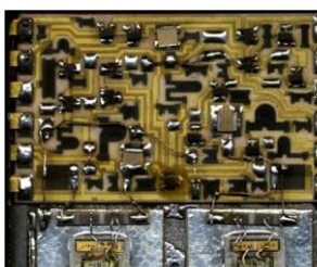
Rysunek 2-2. Hybrydowy układ scalony, wymiary: 5x5 cm
