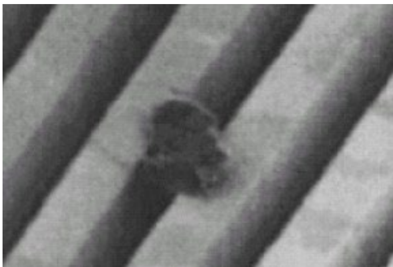
Rysunek 6-1. Przykład defektu - zwarcia ścieżek przewodzących (zdjęcie wykonane mikroskopem elektronowym)
