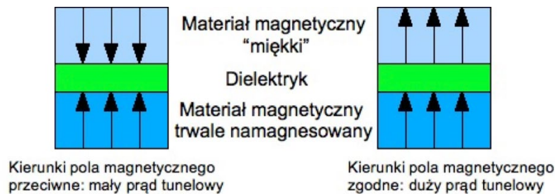
Rysunek 4-12. Idea tunelowego złącza magnetorezystancyjnego
